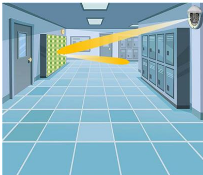
图 4 基于 RIS 辅助的室内覆盖补盲
