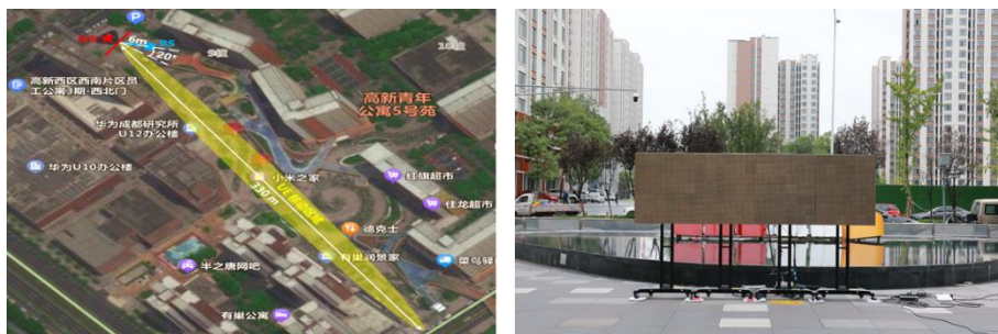
图 39 10GHz 频段的超大规模混合 RIS 的拉远覆盖增强测试环境
